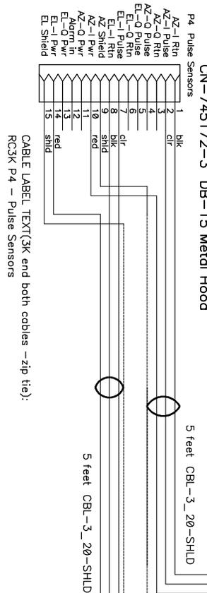
CABLE LABEL TEXT(3K end both cables -zip tie):
